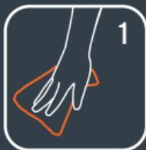
1 La superficie debe quedar libre de suciedad y grasa, se recomienda barrer y luego limpiar con alcohol o acetona ya que el colocar la cinta sobre una superficie sucia, puede producir su desprendimiento.
