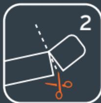
2 Corte la cinta antiderrapante al tamaño deseado redondeando los bordes, no aplique sobre fisuras o uniones de pisos.
