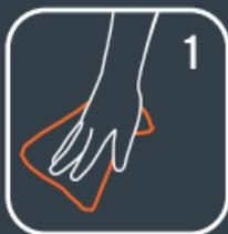
La superficie debe quedar libre de suciedad y grasa, se recomienda barrer y luego limpiar con alcohol o acetona ya que el colocar la cinta sobre una superficie sucia, puede producir su desprendimiento.
