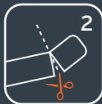
Corte la cinta antiderrapante al tamaño deseado redondeando los bordes, no aplique sobre fisuras o uniones de pisos.
