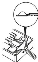
Espera a que la soldadura se enfríe y se endurezca antes de mover la pieza soldada.
