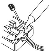
Aplique soldadura a base de colofonia a la pieza y derrítala con el cautín.
