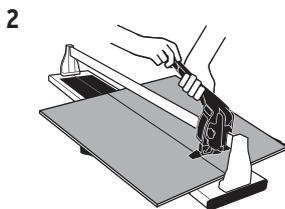
2 Baje el rompedor colocándolo en la parte delantera del mosaico, presione hasta romper el mosaico
