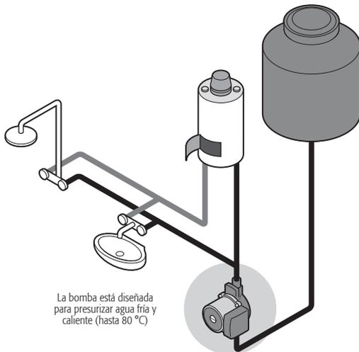
La bomba está diseñada para presurizar agua fría y caliente (hasta 80 °C)
