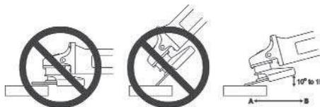
5. Aplique el disco abrasivo hacia la superficie de trabajo con una suave pero persistente presión para una mayor eficiencia de desbaste. No va a ser nunca necesario forzar la herramienta. El peso de la máquina aplica una adecuada presión. Una presión excesiva o repentina sobrecargará el motor, causando una caída en la velocidad del motor y pone en peligro de rotura el disco.
