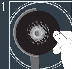
Coloque el respaldo sobre la flecha de la máquina
