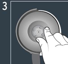
Coloque la contratuercas en la flecha de la máquina
