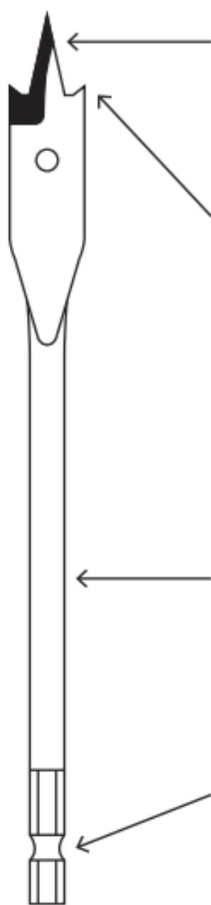
**Diseño con punta guía para perforar en cualquier ángulo**
