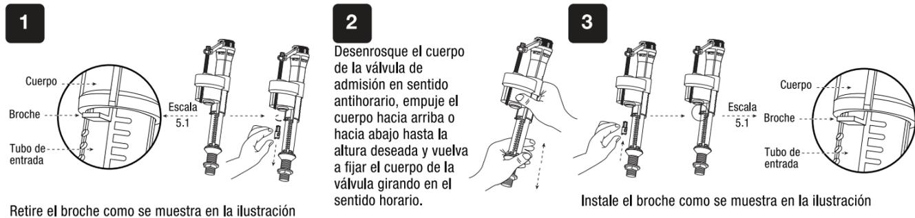
**AJUSTE ALTURA DE FLOTADOR**
