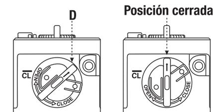
Apunte la flecha hacia el área etiquetada con **D**, inserte el conjunto del sello de cabeza nuevamente en la válvula de entrada, luego gire en sentido antihorario para apretar hasta que la flecha quede recta hacia arriba.
