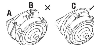
**NOTA:** Asegúrese de que la barra del brazo de bloqueo (con la etiqueta **A**) esté encajada en las dos puntas (con la etiqueta **B**). La posición correcta se muestra en la imagen **C**.
