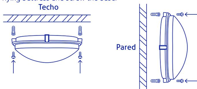
4. Coloque de nuevo la cubierta sobre la pantalla sujetándola con los tornillos laterales.
