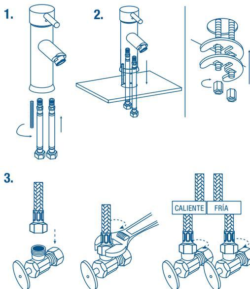
Conecte la alimentación de agua al monomando por medio de las mangueras flexibles (16), enroscando los extremos libres de las mangueras flexibles a las válvulas de paso del agua (Fría o caliente según corresponda). Finalmente, abra el flujo del agua fría y caliente de las válvulas de paso, abra y cierre su monomando varias veces y revise que no existan fugas de agua, en caso de presentarse fugas de agua, apriete firmemente las uniones donde se presenta la fuga.
