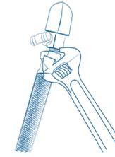
Verifique posibles fugas de gas en las conexiones utilizando agua jabonosa en todas las conexiones, en caso de que exista escape de gas empezarán a formarse burbujas.
