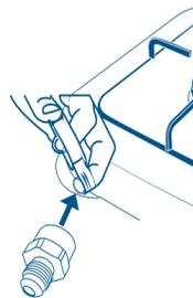
**3** Coloque cinta teflón en el niple campana y después conecte la línea de alimentación para gas (no incluida).
