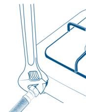
**5** Conecte el otro extremo de la línea de alimentación que esté en la salida de gas.
