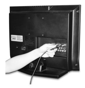
Conecte el final del cable coaxial al contacto de entrada RF del Televisor
