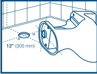
2. Marque los ejes del tubo de desagüe en el piso. Voltee el asiento y marque los ejes en su base, extendiéndolos hacia las superficies laterales.
