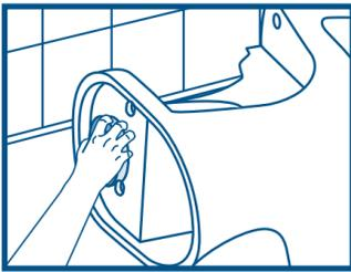
3. Coloque el sanitario de lado, apoyándolo con cuidado sobre un cartón para evitar rayones. Retire la cubierta del cuello de cera y ajústelo firmemente en el desagüe del asiento.
