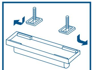
12. Ajuste el asiento en los agujeros de montaje y utilice las tuercas para asegurarlo en su lugar. Asegúrese de que esté nivelado antes de apretar las tuercas. No apriete demasiado.
