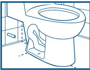
5. Asegúrese de que los ejes marcados en el sanitario del baño coincidan con los marcados en el suelo antes de colocarlo. Luego marque el contorno de la base en el suelo.
