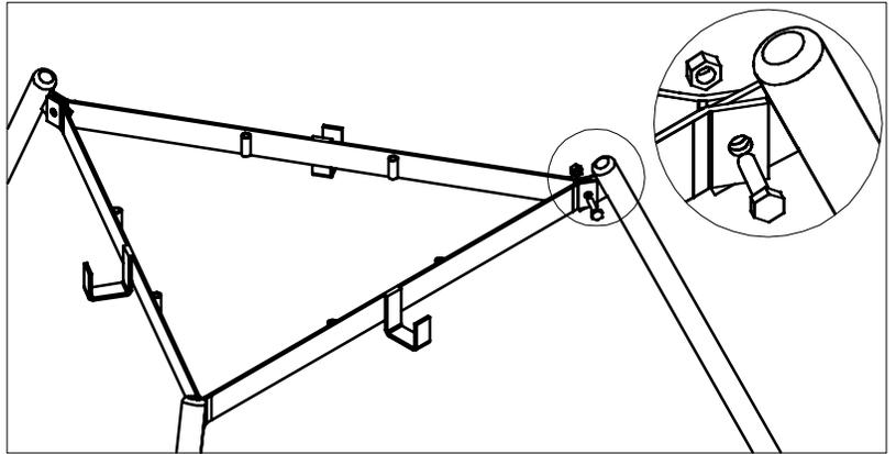
Como se muestra en el dibujo, los postes (B) se atornillan con los soportes superiores (F).
