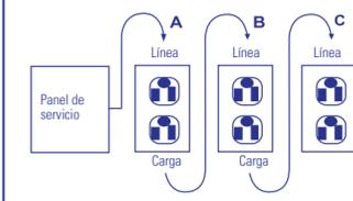
Si se coloca en posición A, esto brindará protección a los interruptores B y C en "lado carga". Por otro lado, si se coloca el GFCI (ICFT) en posición C, esto no protegerá a los interruptores A y B. Recuerde que los interruptores A, B y C pueden colocarse en distintas cámaras.
