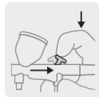
Control de aire y flujo de pintura
