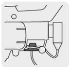
Sujetador de cable para una conexión segura
