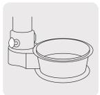
Anillo adaptable para válvulas sin soportes laterales
