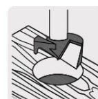
Orificios con fondo plano
