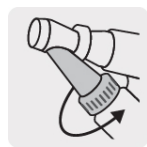
Flujo de pintura
