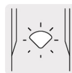
Luz LED que indica encendido
