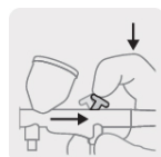
Control de aire y flujo de pintura
