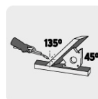
Trabajos a 45° y 135°
