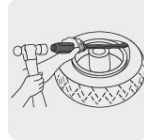
Punta angulada para mayor palanca
