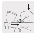
Control de aire y flujo de pintura
