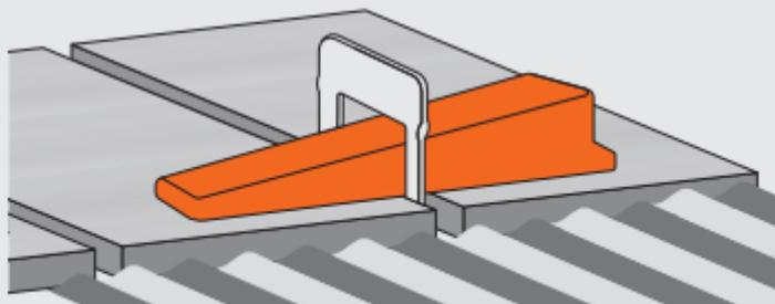
La pinza facilita la nivelación de azulejos en pisos o paredes durante la aplicación
